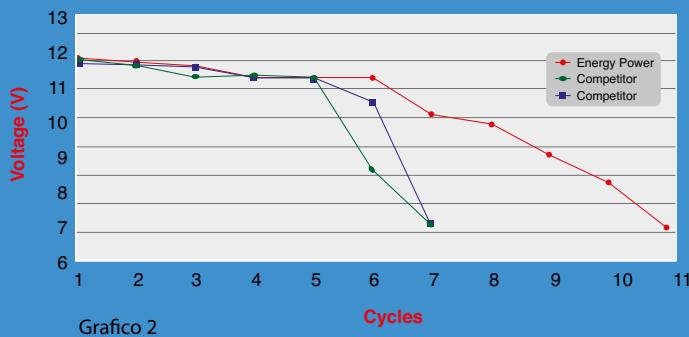
2. Confronto di effetto anticorrosione a condizione di peso specifico 1,280 a 45°C di temperatura ambientale.
